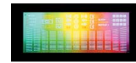
バックライトと組み合わせた表示例 Clear Background VFD with back lighting
